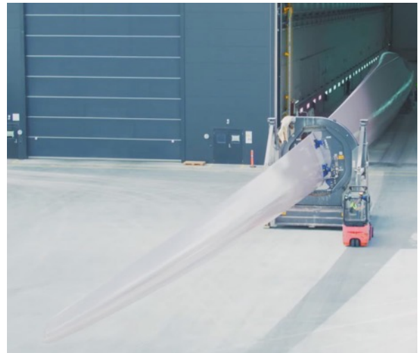
Fig. 9 : une pale 100% recyclable sort d'une ligne de production dans une usine danoise (reneweconomy.com)
